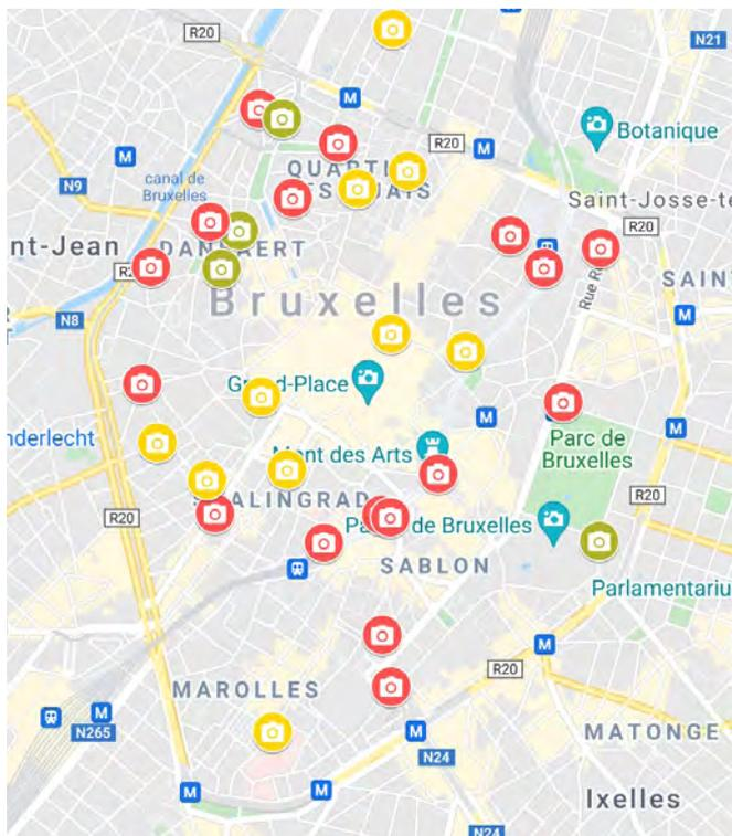
La vitesse V85, ou vitesse du 85<sup>ème</sup> percentile, est la vitesse que 85% des conducteurs ne dépassent pas, et que 15% des conducteurs dépassent. La vitesse V85 donne donc une indication des vitesses typiques pratiquées à un endroit spécifique. Par exemple, si la vitesse V85 est de 36 km/h, cela signifie que 85% des véhicules circulent devant ce radar à une vitesse de 36 km/h ou moins.
